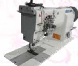
MÁQUINA DE COSTURA PESPONTEIRA ALTERNADA BARRA FIXA 2 AG. C/ LANÇADEIRA GRANDE LH-2252-H
