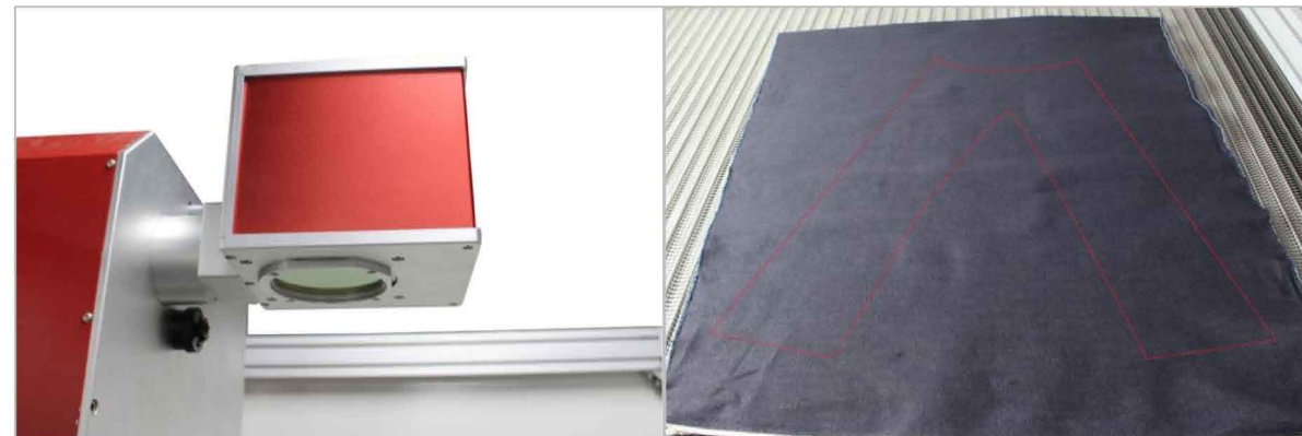
Formação de linhas vermelhas para o posicionamento
